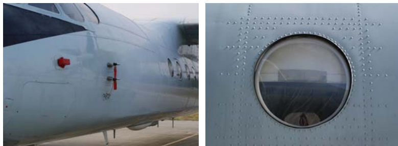
图 3 纳米复合涂料涂装的飞机使用 5 年后仍然保持良好的光泽，无粉化、脱落、锈蚀现象
