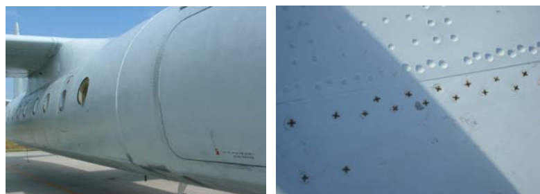
图 4 原使用进口涂料涂装的飞机表面使用不到两年就出现严重粉化、脱落、锈蚀现象
